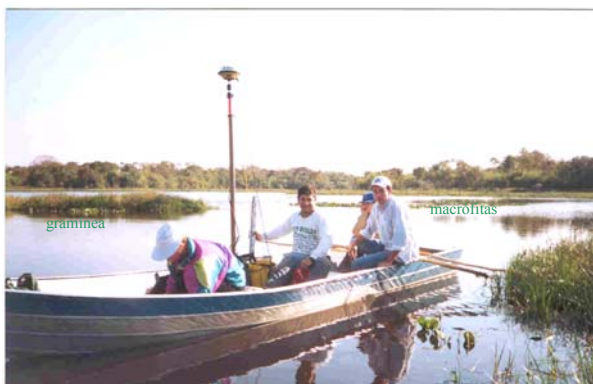
FIGURA 3 – EMBARCAÇÃO ADAPTADA PARA O LEVANTAMENTO BATIMÉTRICO
