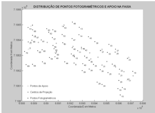
FIGURA 02 – DISTRIBUIÇÃO DE PONTOS FOTOGAMÉTRICOS, CENTROS DE PROJEÇÃO E APOIO NA FAIXA
