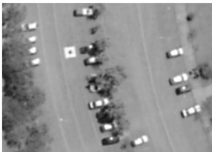
FIGURA 01 – PONTO PRÉ-SINALIZADO CIRCULAR
