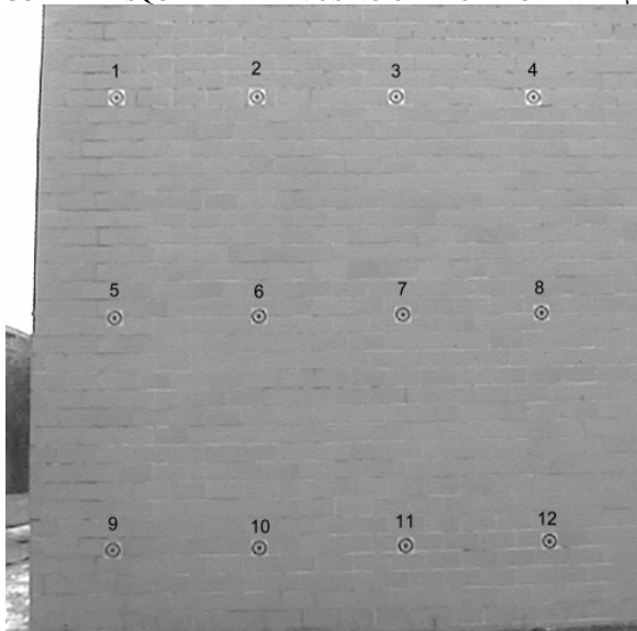
FIGURA 2 – ESQUEMA DE ALVOS NO CAMPO DE CALIBRAÇÃO
