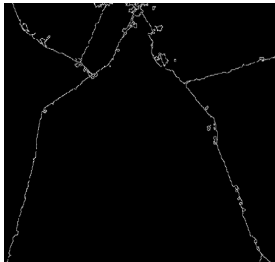
FIGURA 12 - IMAGEM RESULTANTE DO OPERADOR WATERSHED COM IMAGEM ORIGINAL TRATADA E IMAGEM MARCADORA RESULTANTE DOS MÍNIMOS IMPOSTOS.
