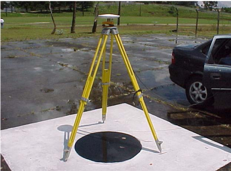
FIGURA 08 – PONTO PRÉ-SINALIZADO CIRCULAR
