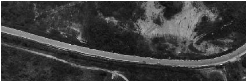
FIGURA 07 - RESULTADO OBTIDO COM O PROCESSO DE EXTRAÇÃO DE SEGMENTOS DE RODOVIA
