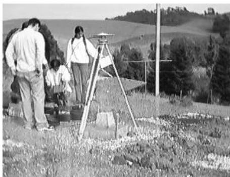
FIGURA 02 - POLIGONAL FECHADA DESENVOLVIDA NO PLANO TOPOGRÁFICO
